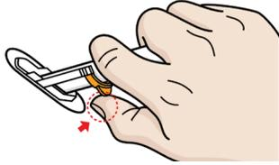
Drücken Sie die Seitenarme, um den Applikator vom Sensor zu trennen.
